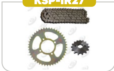
KIT DE SPROCKET CADENA REFORZADA 428H-132L SPROCKET 46T/15T
