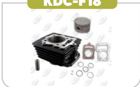
KIT DE CILINDRO NEGRO PISTON BAJO JUEGO: CILINDRO, PERNO, PISTON, ANILLOS, SEGURO, EMPAQUE
