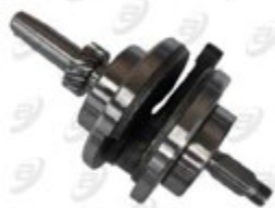
CIGÜEÑAL COMPLETO 63/28/P5 MEDIDA EXTERIOR 68MM
