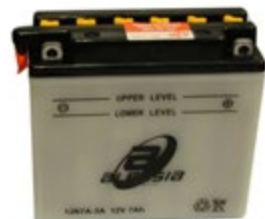
12N7A-3A (POSITIVO A LA DER) 12 Vcc 7 AH (133MM ALTURA / 155MM BASE / 60MM ANCHO)
